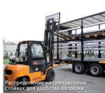
Устройство центральных стоек для погрузки товаров различных высот
