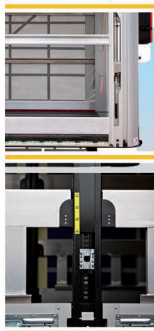
Механизм блокировки центральной стойки после поднятия крыши на требуемый уровень.
