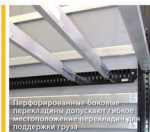
Уровень второго пола с максимальной загрузкой по 900 кг на 22 перекладины
