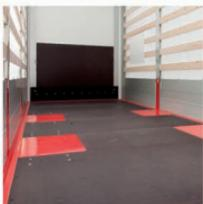
Пол из водостойкой фанеры, максимальный вес вилочного погрузчика – 5 500 кг
